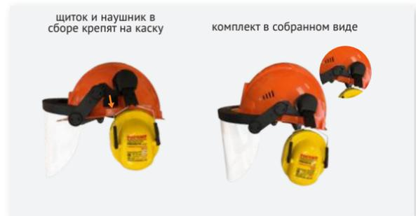
4. Проверьте правильность сборки комплекта: в рабочем положении наушники должны плотно прилегать к голове, в нерабочем - отведены от головы и прижаты к задней части корпуса каски. Проверьте, чтобы не было зазора между козырьком каски и щитком КБТ.
