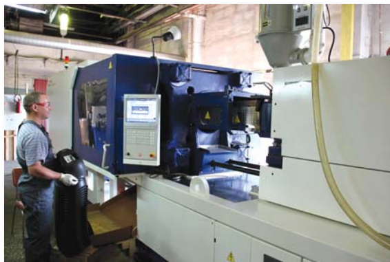
Отливка корпуса щитка сварщика на термопластавтомате
